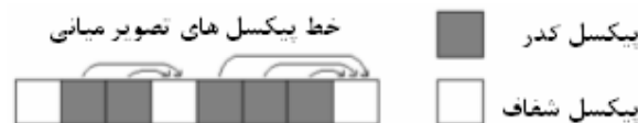
شکل ۳- چنانچه پیکسلی از تصویر میانی کدر شده بود می توان از آن پیکسل و واکسل های متناظر آن صرف نظر کرد.
